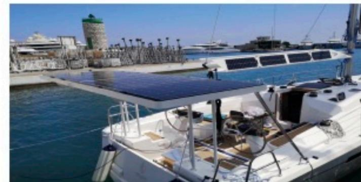
Elektrotechnische Installation des Solar-Großsegelbaums und des Solar-Heckspoilers an Bord der VIKO S35 Segelyacht im Yachthafen von Antibes
